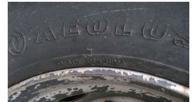
Reifen: Profiltiefe < 7 mm Anmerkung: Der Reifenverschleiß wird in der am meisten abgenutzten Profiltrille am Reifen gemessen.
