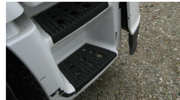
Materialabtrag, defektes Teil
