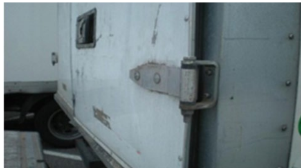
↻ Seitliche und hintere Türen: Türen an den Scharnieranschlüssen verbogen, gebrochen, durchstoßen oder nicht auf wirtschaftliche Weise reparabel
