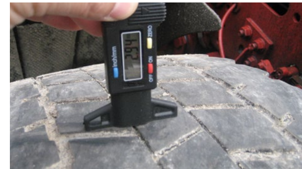
Reifen: Reifenverschleißanzeige > 3 mm, abgetragen
