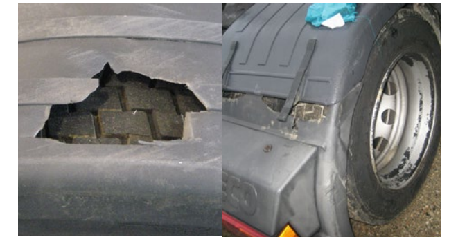
Materialabtrag, defektes Teil
