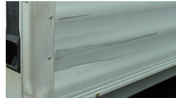
Verformungen in den Schienen, die auf wirtschaftliche Weise repariert werden können, Schließung nicht möglich oder nicht sanddicht
